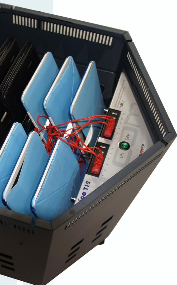
Ma il cuore pulsante di **Unica T 12** è l'alimentazione intelligente "AIR", (**Automatic Individual Regulation**) dove ogni Tablet dispone di una presa USB con regolazione automatica indipendente, per fornire sempre e solo l'energia necessaria e sospendere del tutto quando carico al 100%
